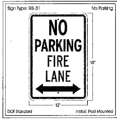
FIRE LANE SIGN DETAIL N.T.S.
